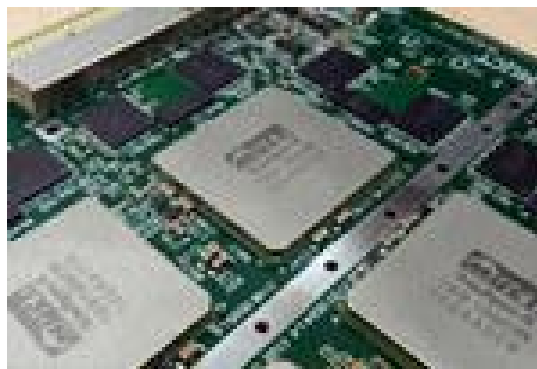
Рис. 1. Микропроцессор на платформе «Эльбрус», применяемый в ракетно-космической отрасли
