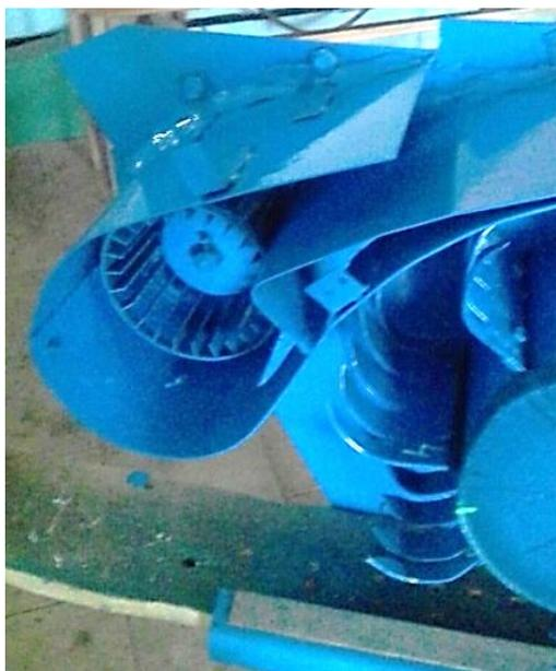
**Рис. 2. Установка дополнительного вентилятора**
