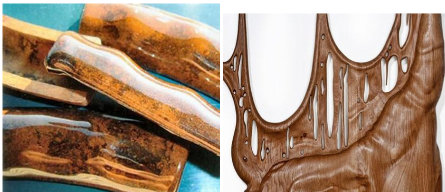
Рисунок 1 – Жидкая древесина – арбоформ
