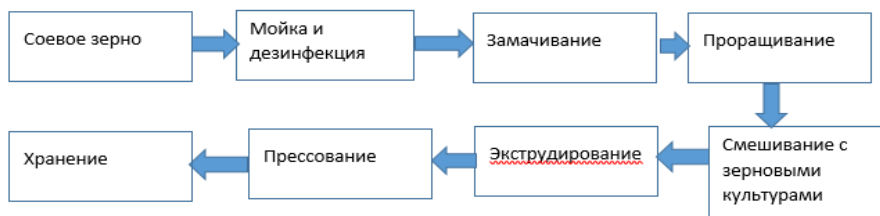
Рисунок 2 – Технология получения кормового продукта из соевых ростков
