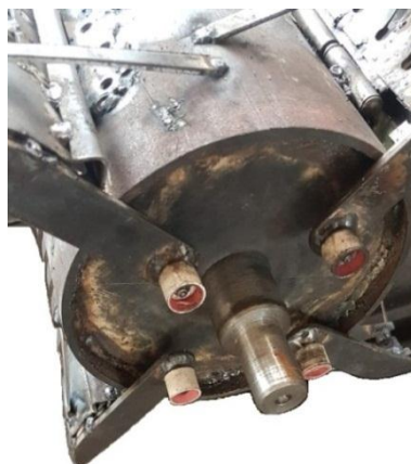
Рисунок 2 – Шарнирное крепление гребенок на очесывающем барабане
