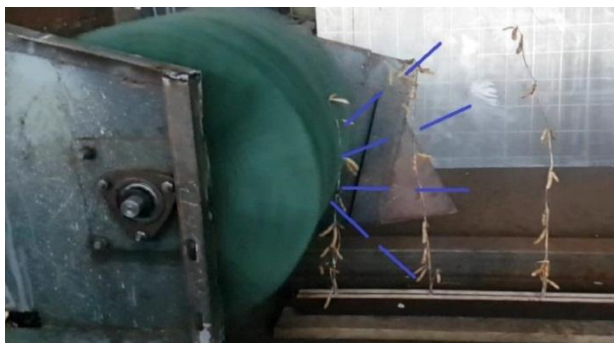
Рисунок 3 – Траектория полета зерна при работе очесывающего устройства с полипропиленовыми щетками
