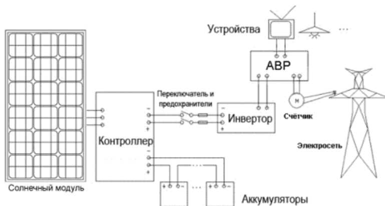
Рисунок 2 – Схема работы солнечной батареи
