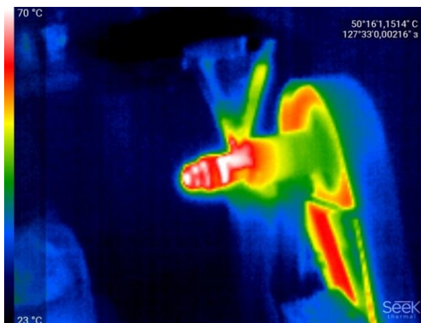
Рисунок 2 – Термограмма экструдера в процессе работы
