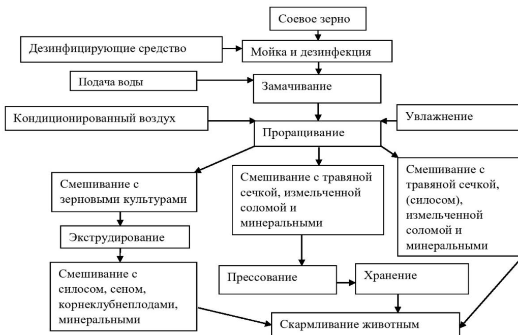
Рисунок 1 – Технологическая схема производства кормов на основе пророщенного соевого зерна
