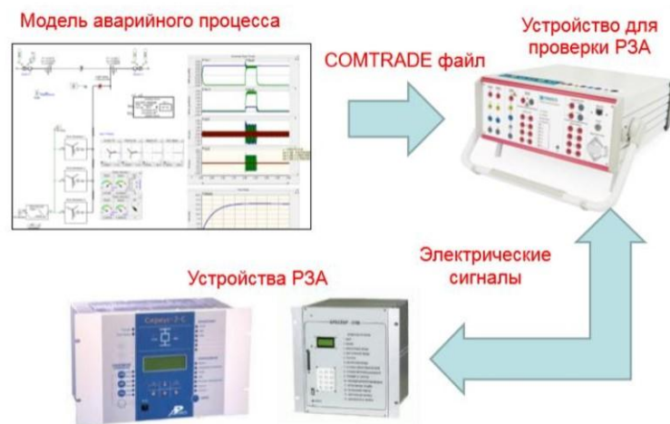
Рисунок 1 – Функциональная схема стенда для изучения устройств РЗА
