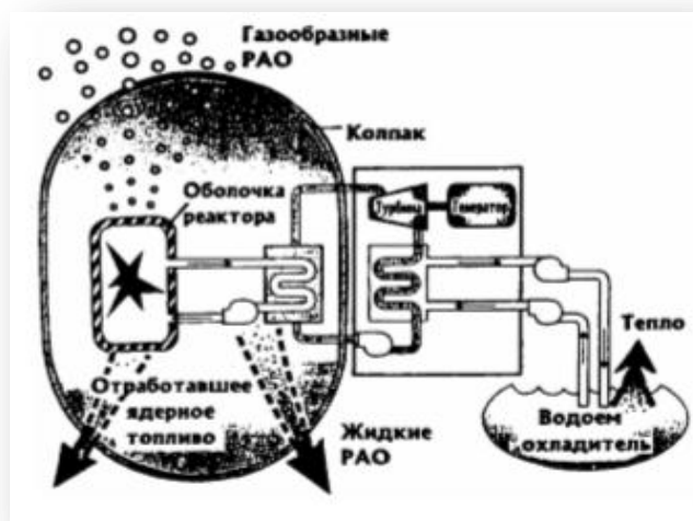
Рисунок 1 – Схема образования газообразных, жидких, твердых отходов и теплового загрязнения от АЭС
