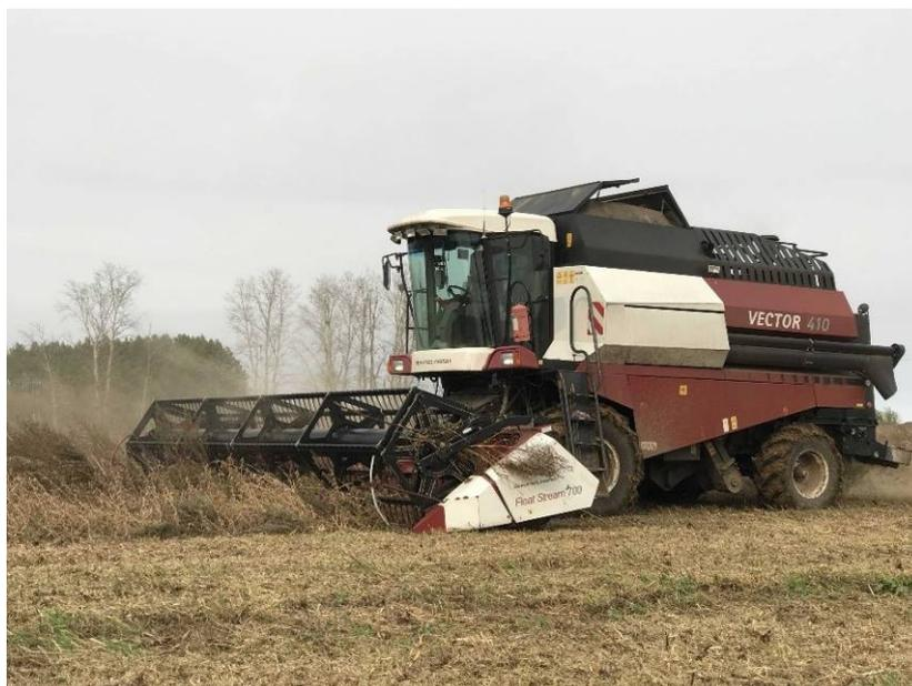
Рисунок 1 – Зерноуборочный комбайн Vector 410 на уборке сои
