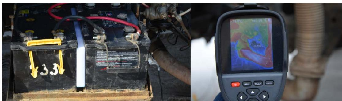
Рисунок 2 - Подогреватель АКБ и фрагмент замера тепловизором
