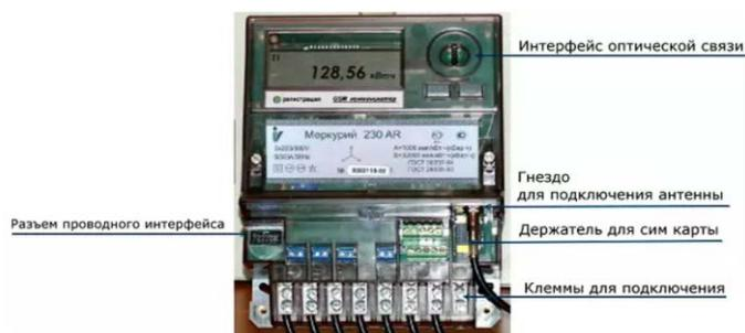
Рисунок 2 - Части электросчётчика с передающим устройством
