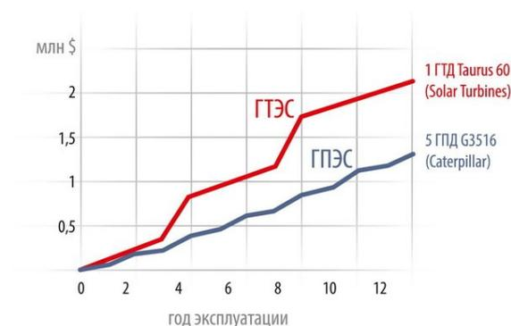
Рисунок 2 – Эксплуатационные затраты на электростанцию мощностью 5 МВт
